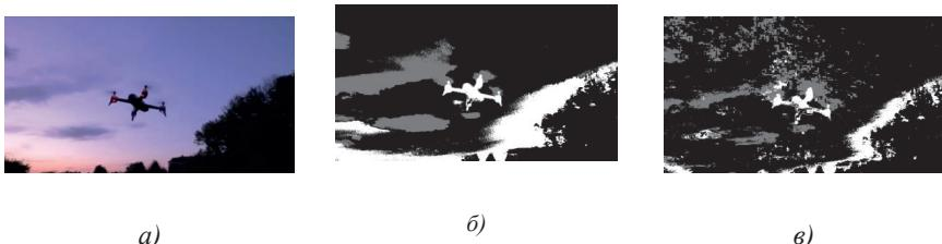
Рис. 3. Сравнение методов вычитания фона: а – оригинальное изображение; б – метод  $k$ -NN; в – метод *MOG2*
