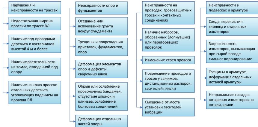
Рис. 1. Характерные неисправности на ЛЭП
